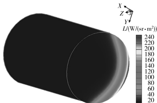
图 13 某相对空间位置羽流辐射亮度投影图
